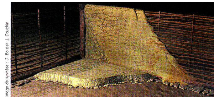
Restitution du mode de construction des bâtiments gaulois.
