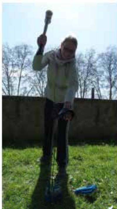
**Photographie 2 :** application du pénétromètre FANDA au séminaire Clôtre Saint-Aignan. Le sondage en cours de réalisation sur cette photographie correspond à SP15.
