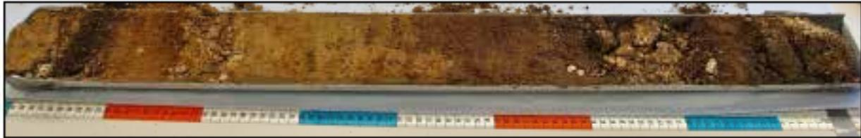
Figure 4 : Photographie d'une demi-section de la carotte SC3 6,3-7,2 après ouverture. Cette photographie montre bien la présence de différents faciès dans les sondages carottés.
