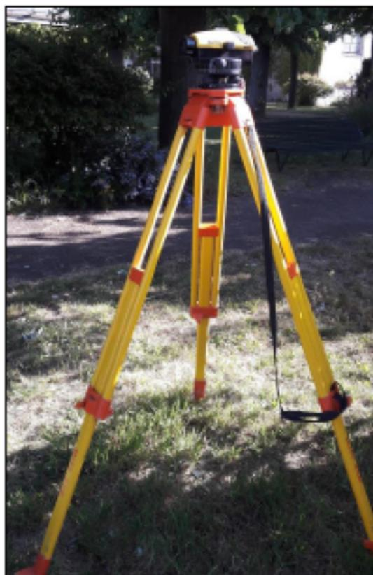
Figure 6 : Niveau optique sur trépied utilisé pour les relevés topographiques
