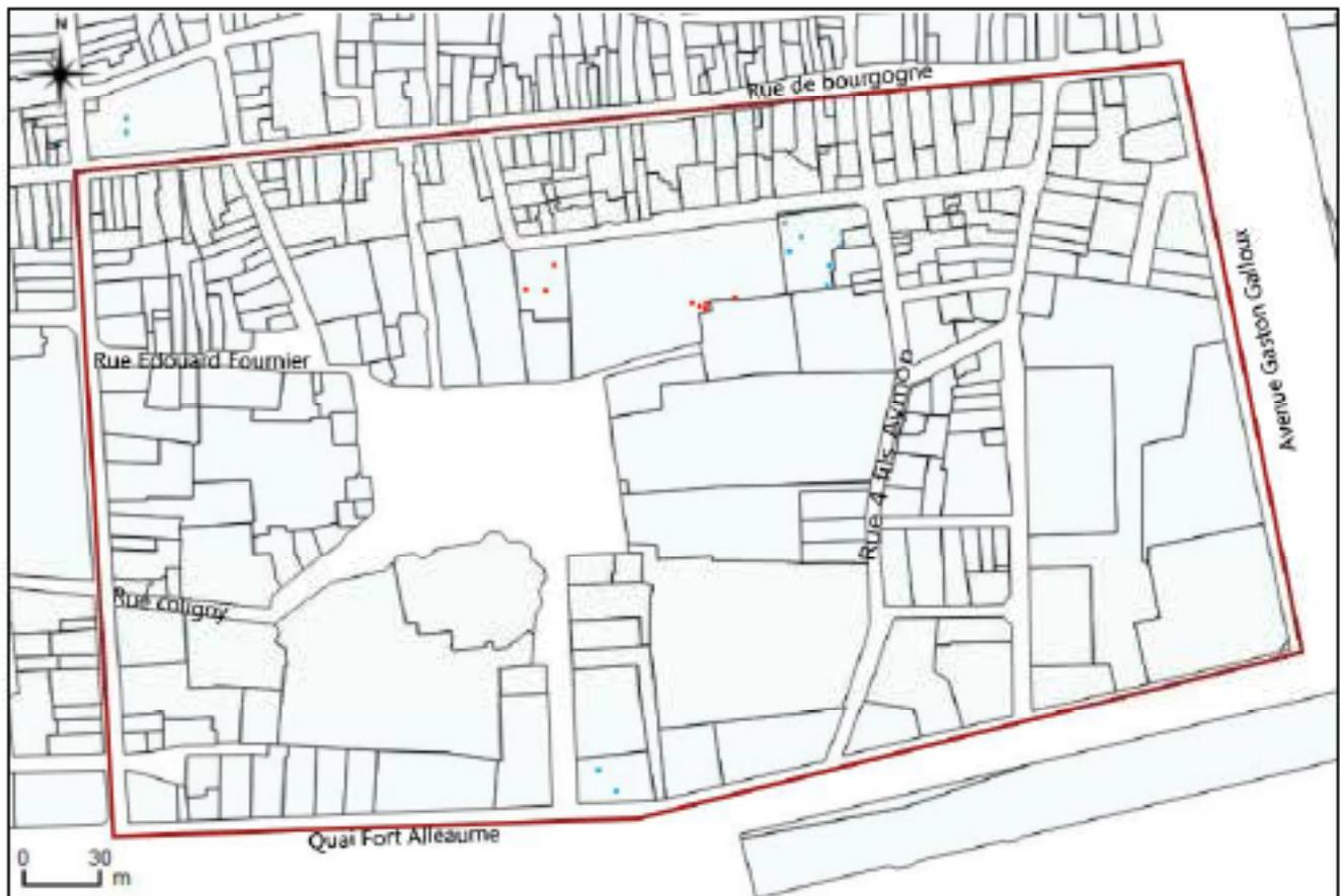
Figure 16 : Carte SIG des sondages géotechniques réalisés par des personnes externes. En bleu, sont représentés les sondages disposant d'un indice de confiance de 0, ils sont donc peu fiables mais permettent tout même de se faire une idée. En rouge, sont illustrés les sondages ayant un indice de confiance compris entre 1 et 2, ils sont donc exploitables.
