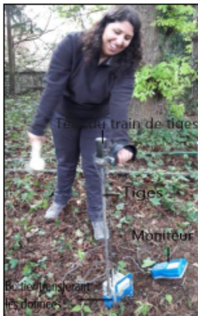
Figure 5 : Photographie du PANDA avec la représentation des tiges, de la tête du train de tiges, du moniteur et du boîtier.
