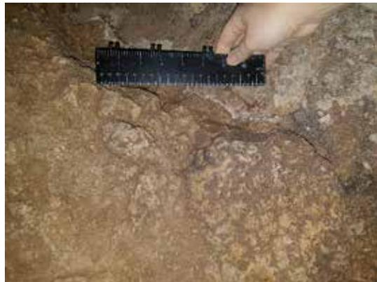
*Calcaire à pâte argileuse. De petits blocs de calcaires peuvent se retirer facilement (I3.2)*
